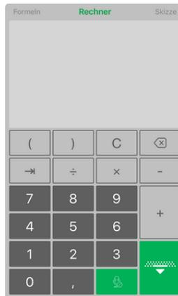
Um Messwerte von einem verbundenen Distanzmessgerät zu übernehmen, führen Sie die Messung durch. Der ermittelte Messwert wird automatisch im Eingabefeld angezeigt. Sie können diesen nun übernehmen oder einen Rechenoperator (Plus, Minus, Mal, Geteilt, ...) eingeben und einen weiteren Messwert per Bluetooth abrufen.
