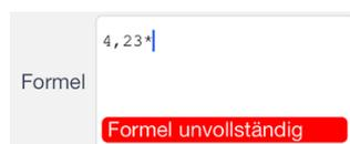
Es können beliebig viele Massenansätze eingefügt werden. Die Einzelergebnisse werden (später in MOS'aik) in der jeweiligen Position des Vorgangs aufsummiert. Damit können Sie Einzelmessungen für alle Bauteile (z.B. Wände, Türen, Fenster) aufnehmen und jeweils mit einem entsprechenden Vorzeichen (im *Faktor*) berücksichtigen.
